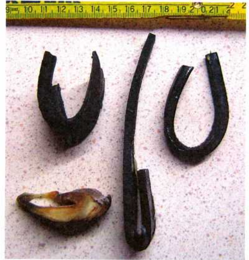
Abb. 1: Gebogene Hornstreifen nach einem dreiminütigen Bad in siedendem Öl. Bis auf das ursprünglich runde Ziegenhorn (links unten) waren alle Proben vor dem Biegevorgang gestreckt.
