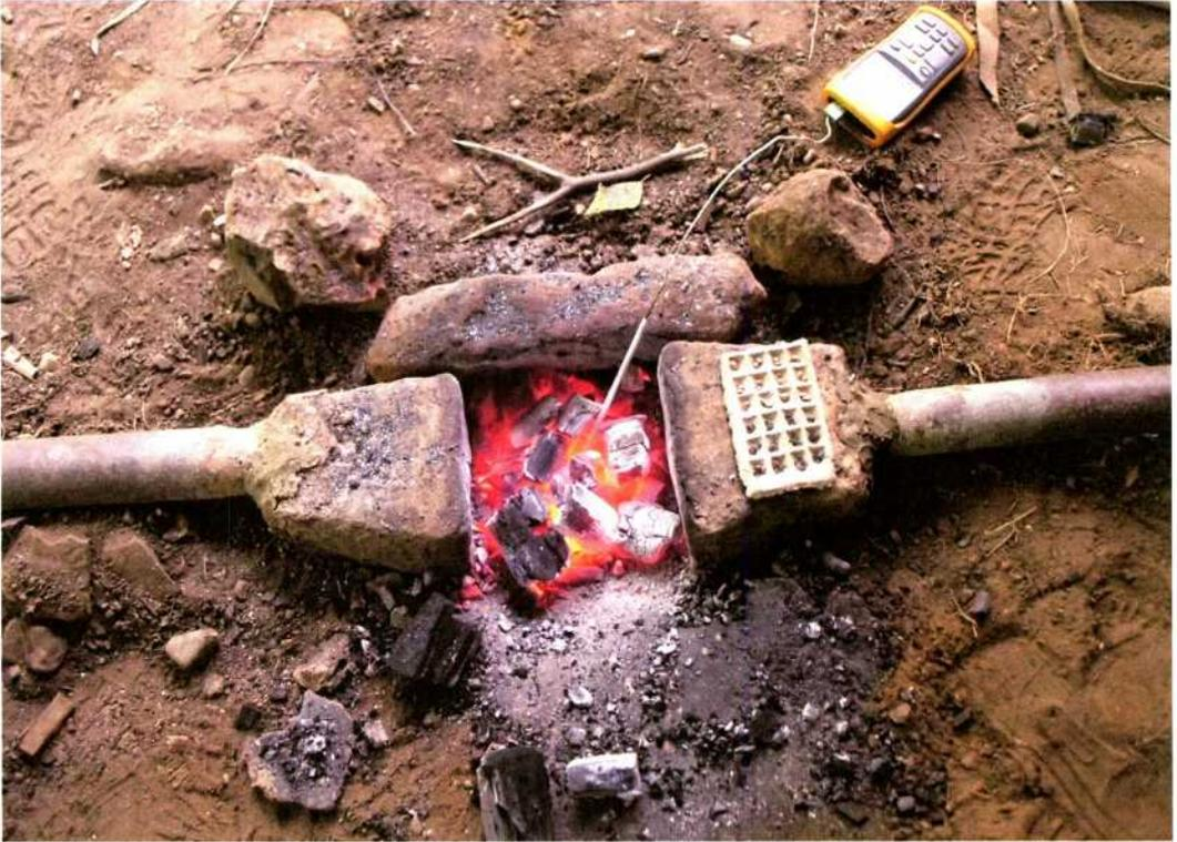
Abb. 9: Schmelzofen mit Luftzufuhr durch Düsenziegel.
