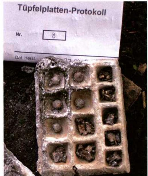
Abb. 10: Für die Vorversuche verwendete Tüpfelplatte mit kugelförmigen Schrötlingen (links) und starker Verschlackung.
