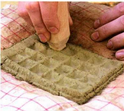
Abb. 8: Stempeln der Vertiefungen in die Tonplatten.
