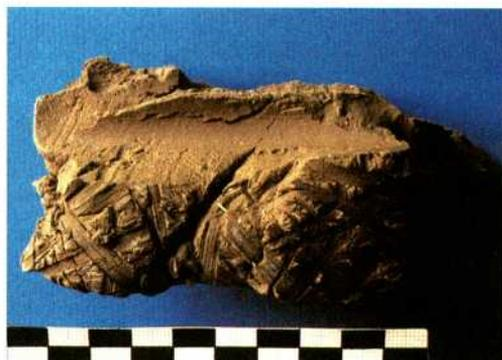
Abb. 6: Lehm aus einer nachgebauten Flechtwand mit Grasabdrücken. Die Strukturen gleichen denen des bronzezeitlichen Hüttenlehms.
