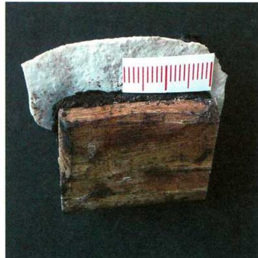
Abb. 8: Pech mit gleicher Gewichtsmenge feingesiebter Holzasche vermischt. Abmessungen eines daraus hergestellten Würfels seit September 2010 unverändert. Ein Teil der Probe zum Einkitten einer Feuersteinklinge in einen Holzgriff verwendet.
