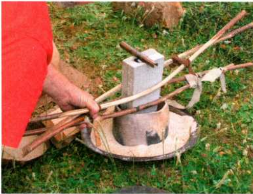
Abb. 5: Die Formhälften werden mit Hilfe von Haselruten zusammengehalten, der Kern wird an einer Bronzeschiene in der Form fixiert.
