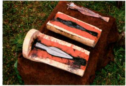
Abb. 12: Die Formkästen und die darin gegossene Lanzenspitze.
