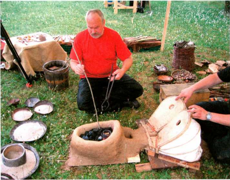
Abb. 2: Der Schmelzofen mit Verbindungskanal zu Blasebälgen und Tiegel.
