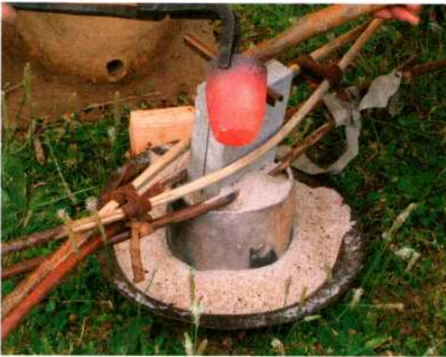
Abb. 6: Die Bronze wird am Kern vorbei in die Form gegossen.
