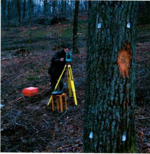
Abb. 2: Einmessen der Eiche mit dem Tachymeter.
