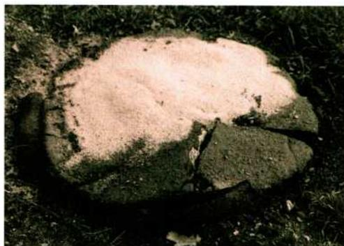
Abb. 6: Erste Phase des Langzeitversuches. Die Lehmplatte ist nach etwa 3 Monaten zerbrochen, der Plattenrand beginnt sich aufzulösen. Die Holzkohle ist schützend abgedeckt, die Stützhölzer liegen z. T. frei. Der Röstsand liegt noch weitgehend auf der Platte, z. T. ist er abgeschwemmt und durch die Spalten geflossen.
