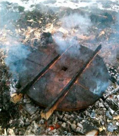
*Abb. 9: Nach der Hochtemperaturphase erfolgt die Abkühlung des angefeuchteten Rades.*
