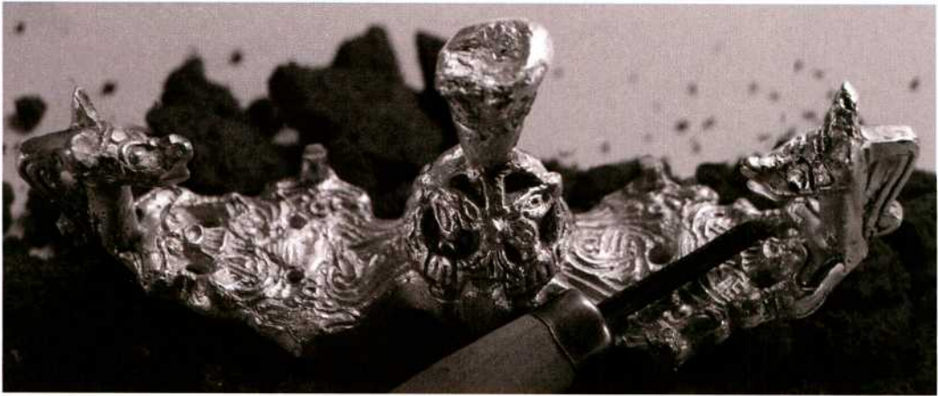
Abb. 9: Die Silberspange beim Ziselieren.
