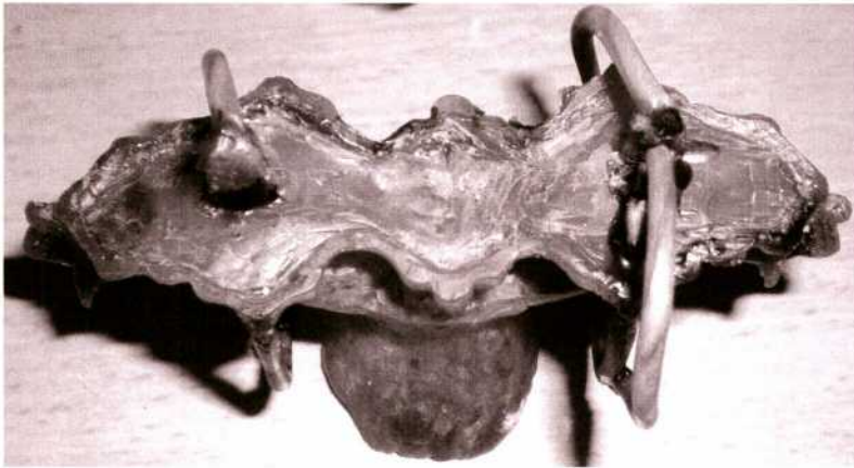
Abb. 7: Beispiel für euterförmigen Einguss und vernetzte Windpfeifen.
