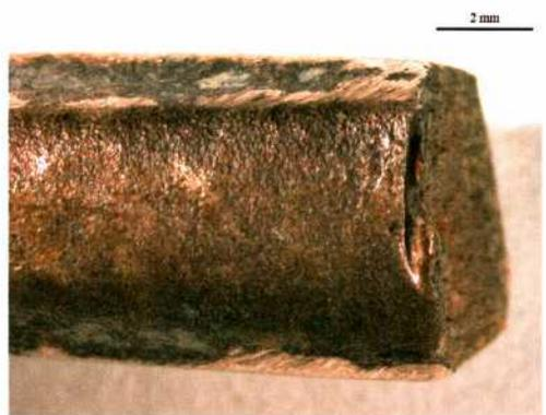
Abb. 4: Bruchstelle am Griffende zum Ansatz des Eingusstrichters. Links Griffdornmesser (Inv.-Nr. 1277-6), rechts Replikat.
