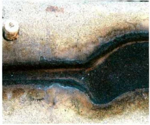
Abb. 3: Ausbesserung mit Ton an einem Messernegativ in einer Sandsteingussform. Links Originalgussform von Zürich-Alpenquai (Inv.-Nr. AQ26073), rechts für die Herstellung der Replikate verwendete Gussform.
