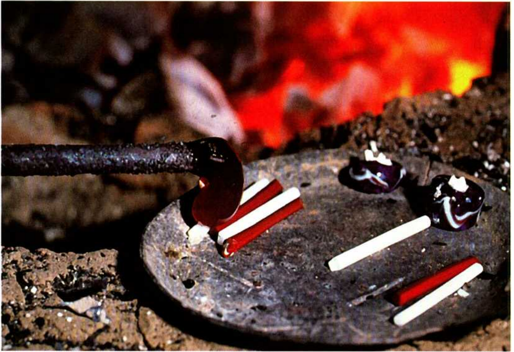
Abb. 4: Aufbau eines Fadenbandes. Rote und weiße Fadenstückchen werden auf blaues Glas (im Bild rotglühend) angeschmolzen. Foto: H. Rasmussen, Lejre.
