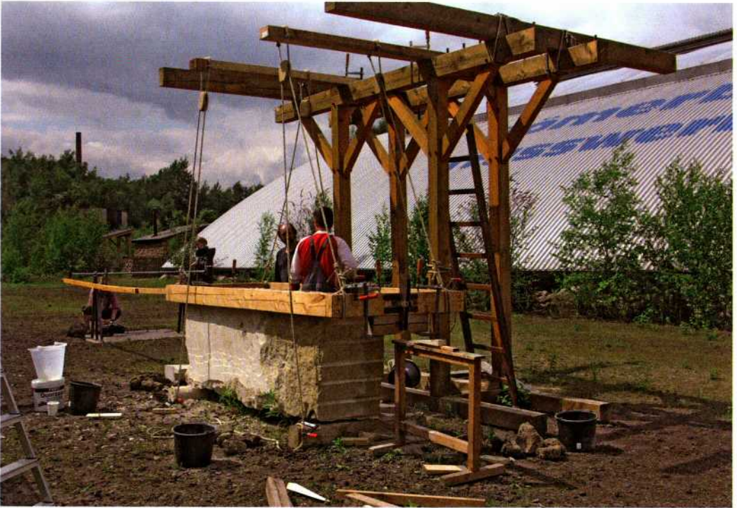
Abb. 3: Wassergetriebene byzantinische Steinsäge von Ephesos, Türkei, Funktionsmodell. Das Wasserrad ist durch einen Elektroantrieb ersetzt. Von dessen Kurbel aus geht die Schubstange zum Sägerahmen, welcher an seinen vier Ecken an einer Galgenkonstruktion aufgehängt ist.
