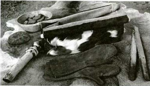
Abb. 24: Ein Paar Lederhandschuhe, ein Schlauchgebläse und eine Holzzange als Hilfsmittel für das Aufglühen und Manipulieren der Gusskuchen und ihrer Teilstücke (im Hintergrund, links).
