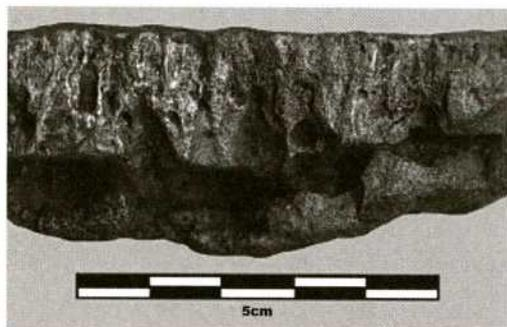
Abb. 3: Seitenansicht eines geviertelten Gusskuchens mit Gasblasen und Hohlräumen. Steiermark, Kainischtal-Rabenwand, Depotfund 6.
