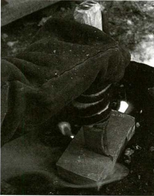
Abb. 19: Einkerbung eines soliden Quaders aus Elektrolytkupfer mittels Abschröter.
