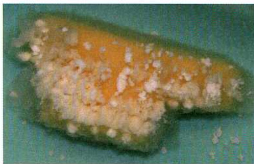
Abb. 9: Reaktion von Elfenbein nach einer Woche in Ameisensäurelösung.
