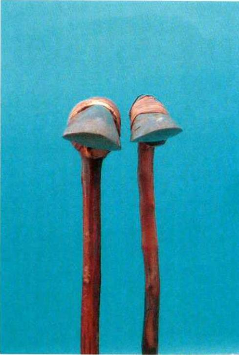
Abb. 4: Die Dechselbeile sind in der Regel an die dominante Hand des Benutzers angepasst. Links im Bild eine Rechtshänderdechsel, rechts eine Linkshänderdechsel. – Most adzes are adapted to the users most frequently used hand (the dominating hand). Left: a right-handed adze. Right: a left-handed adze.
