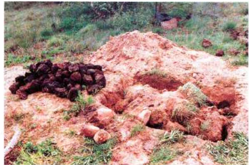
Abb. 3: Erz vor Röstung mit abgedeckter Röstgrube. – Bog ore before roasting with covered roast-pit.
