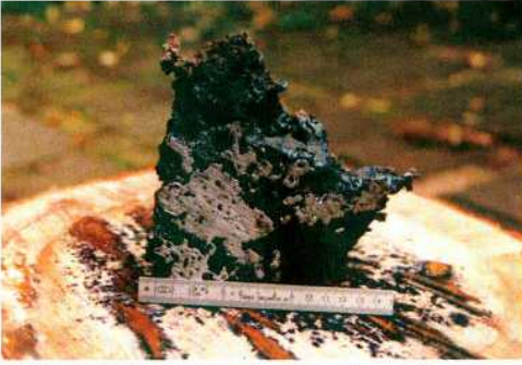
Abb. 6: Schnitt durch eine Luppe. – Sectional view of a bloom.
