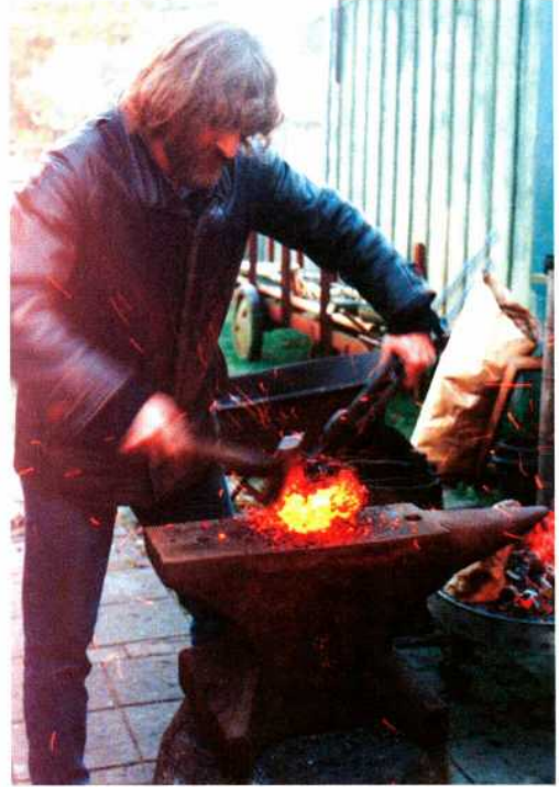
Abb. 7: Ausschmieden der Luppe. – Forging the bloom.
