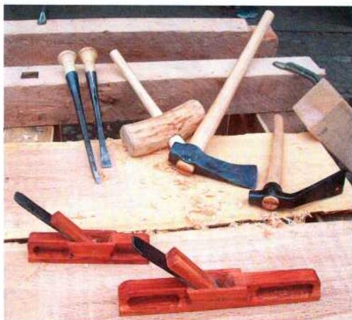
Abb. 12: Ein Teil der Arbeiten wurde mit nachgebildeten römischen Werkzeugen ausgeführt. – A part of the work was carried out using reconstructed roman tools.
