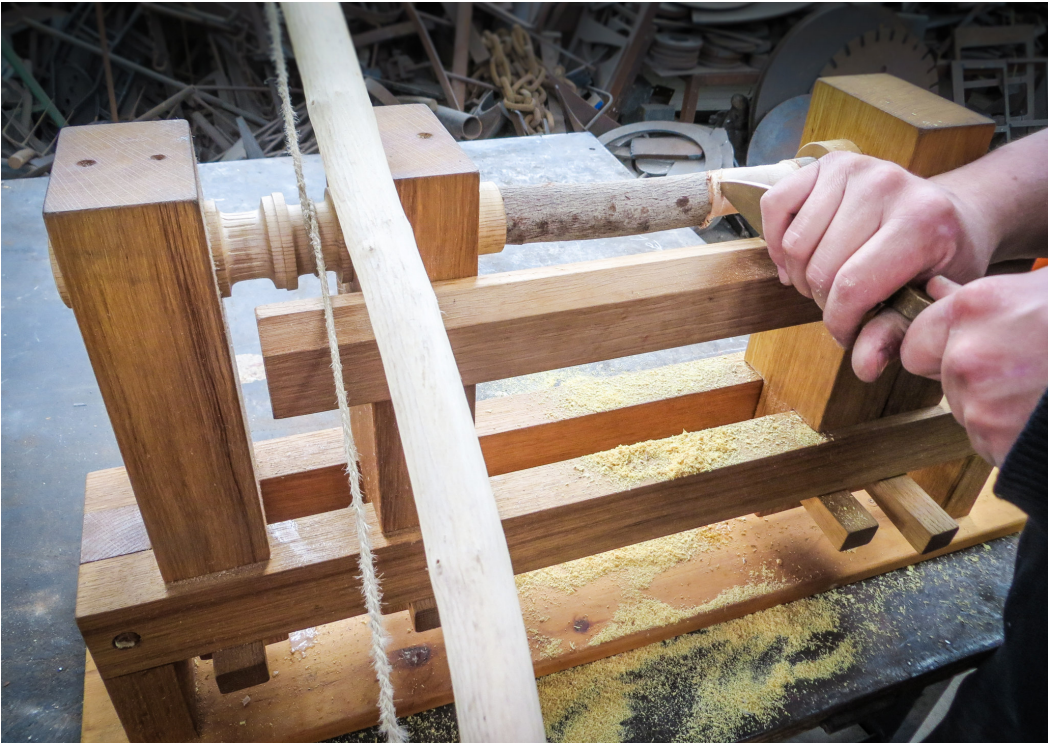
Abb. 7: Ausdrehen des Rohlings auf einem Nachbau einer römischen Drechselbank. – Turning the blank with a reproduction of a roman woodturning lathe.
