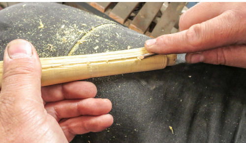
Abb. 8: Herstellung der Rillen für die Kannelur des Mittelstückes. – Making of the middle piece's fluting.
