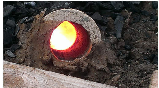
Abb. 17: Looking down the clay tuyere into the furnace during a smelt. The flame colour indicates a temperature of about 1100°C. – Blick durch die Lehmduße in die Schmelzgrube während des Schmelzprozesses. Die Farbe der Flamme zeigt eine Temperatur von etwa 1100°C an.
