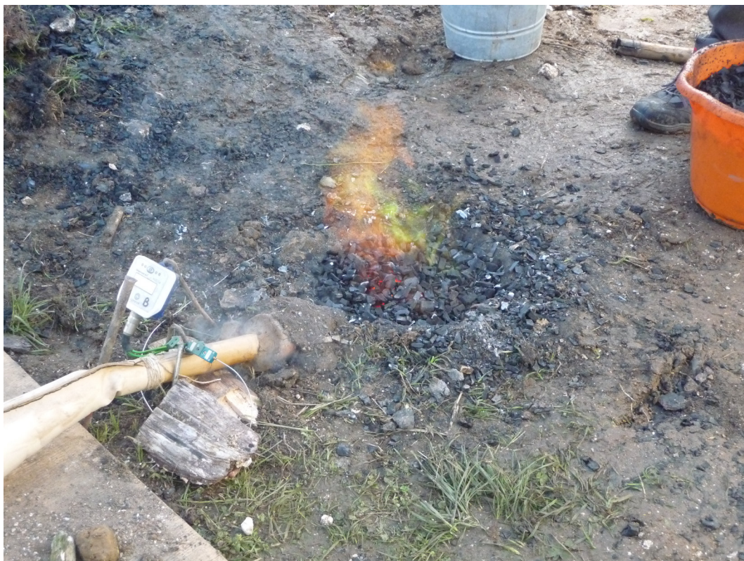
Abb. 18: Green and mauve coloured flames issuing from the top of a small pit furnace. This indicates reducing conditions as well as the commencement of copper smelting. – Grüne und fliederfarbene Flammen schlagen aus der Spitze eines kleinen Grubenofens heraus. Dies zeigt eine reduzierende Atmosphäre im Inneren der Grube sowie den Beginn der Kupferschmelze an.
