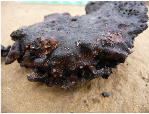
Abb. 19: A conglomeratic slag cake enclosing prills (droplets) of copper formed during the smelting of a self-fluxing oxidised copper ore. Pločnik, Serbia 2013. – „Schlackenkuchen“; Konglomerat mit eingeschlossenen Kupfertropfen, die sich während des Schmelzens eines selbstfließenden, oxydierenden Kupfererzes bilden, Pločnik, Serbien, 2013.
