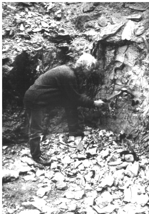
Abb. 7: Mining experiment using an antler pick at the experimental site on Copa Hill, Cwmystwyth in the 1990s. – Abbauexperiment unter Verwendung einer Geweihhacke auf dem Versuchsgelände von Copa Hill, Cwmystwyth, in den 1990er-Jahren.
