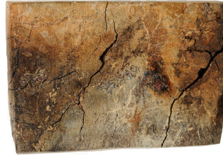
Abb. 7: Oxidierend, 30 Minuten, 1100°C. Aufsicht, Seitenansicht und Querschnitt. Die Aufsichtsseite wurde durch die Luftzufuhr gekühlt. Der Serpentin hat sich an dieser Stelle (dunkel) bis in den Kern kaum verändert. – Oxidizing, 30 minutes, 1100°C. Top view, side view and cross section. The top view was cooled down by the air supply during the heating process. At this section (dark colour), the serpentinite did not alter.
