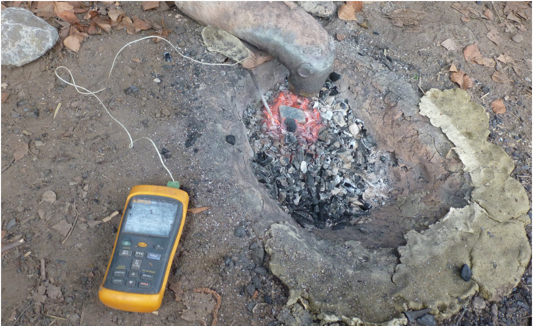
Abb. 4: Die Ofenkonstruktion. Zu sehen ist ein oxidierender Brennversuch, die Steinprobe ist nicht mit Holzkohle überdeckt. Der Hotspot zeichnet sich durch die rot glühende Holzkohle ab. – A stone sample being heated in the furnace under oxidizing conditions. The top side of the sample is not covered with charcoal. The glowing charcoal marks the hot spot.
