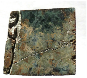
Abb. 7: Oxidierend, 30 Minuten, 1100°C. Aufsicht, Seitenansicht und Querschnitt. Die Aufsichtsseite wurde durch die Luftzufuhr gekühlt. Der Serpentin hat sich an dieser Stelle (dunkel) bis in den Kern kaum verändert. – Oxidizing, 30 minutes, 1100°C. Top view, side view and cross section. The top view was cooled down by the air supply during the heating process. At this section (dark colour), the serpentinite did not alter.
