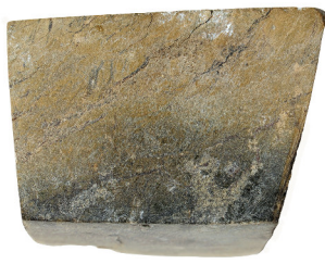
Abb. 8: Reduzierend, zehn Minuten, 800°C. Seitenansicht und Querschnitt (links und Mitte). Reduzierend, 30 Minuten, 800°C (rechts). – Reducing, ten minutes, 800°C. Side view and cross section (left and middle sample). Reducing, 30 minutes, 800°C (right sample).
