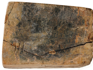
Abb. 7: Oxidierend, 30 Minuten, 1100°C. Aufsicht, Seitenansicht und Querschnitt. Die Aufsichtsseite wurde durch die Luftzufuhr gekühlt. Der Serpentin hat sich an dieser Stelle (dunkel) bis in den Kern kaum verändert. – Oxidizing, 30 minutes, 1100°C. Top view, side view and cross section. The top view was cooled down by the air supply during the heating process. At this section (dark colour), the serpentinite did not alter.
