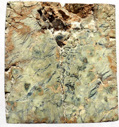
Abb. 8: Reduzierend, zehn Minuten, 800°C. Seitenansicht und Querschnitt (links und Mitte). Reduzierend, 30 Minuten, 800°C (rechts). – Reducing, ten minutes, 800°C. Side view and cross section (left and middle sample). Reducing, 30 minutes, 800°C (right sample).
